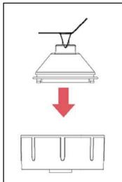
3. Skruva fast anslutningsstycket på glasbehållaren så det sitter ordentligt fast.
