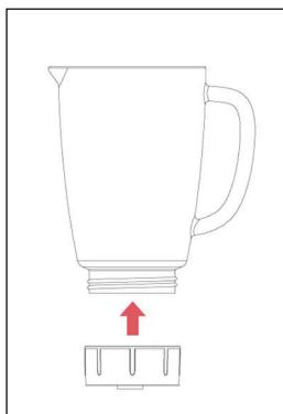
4. Sett glassbeholderen med knivenhetsadapteren på hovedenheten.
