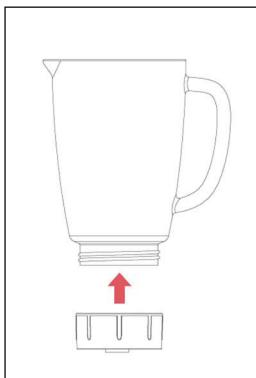
4. Placera glasbehållaren med knivenheten på motorn. Handtaget kan placeras i två lägen: endera åt höger eller åt vänster.
