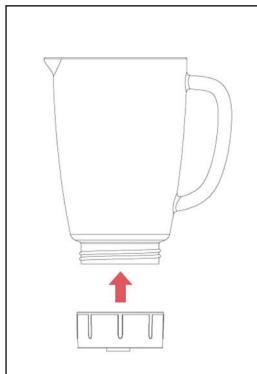
4. Aseta lasikannu ja teräyksikkö sovittimineen moottoriosaan. Kahvan voi asettaa kahteen asentoon: vasemmalle tai oikealle puolelle.
