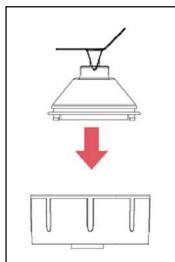
3. Skru berøringsfladen fast i bunden af glaskanden, til den sidder fast.
